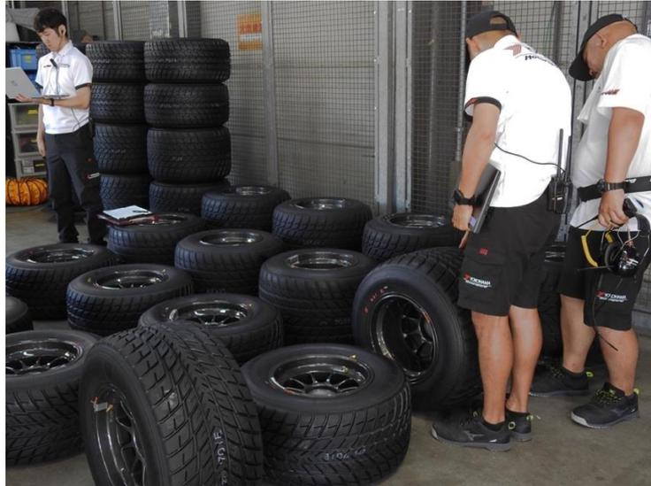
午前のテスト走行では今シーズン採用されているカーボンニュートラル素材を使用したレインタイヤに2種類の違うコンパウンドを装着しての評価テスト、午後には昨年11月の同じくウエット路面テストで高評価のあったタイヤを使用し、夏の高温時に走行した場合の評価テストを行いました。
